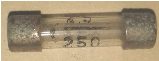
Bild 7; Grünspan am Sicherungshalter und an der Sicherung
