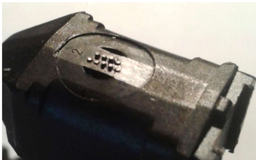
Bild 9: Nadeldruckkopf mit festgeklebten Nadeln
