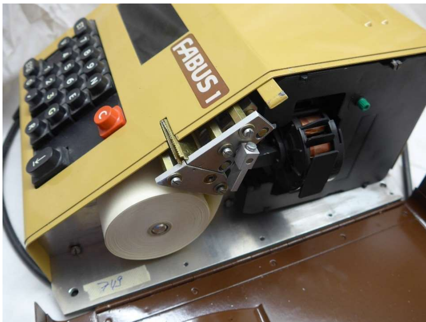
Bild 2: Das Nadeldruckwerk mit Farbbandkassette und Papierantrieb, der Fahrschein wurde mit der Hand abgerissen
