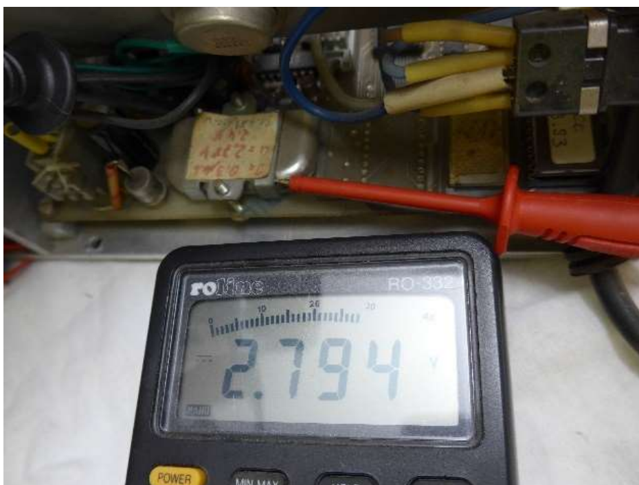
Bild 12: Die gleiche Spannung wie zur Produktionszeit (wahrscheinlich) 11.04.1987
